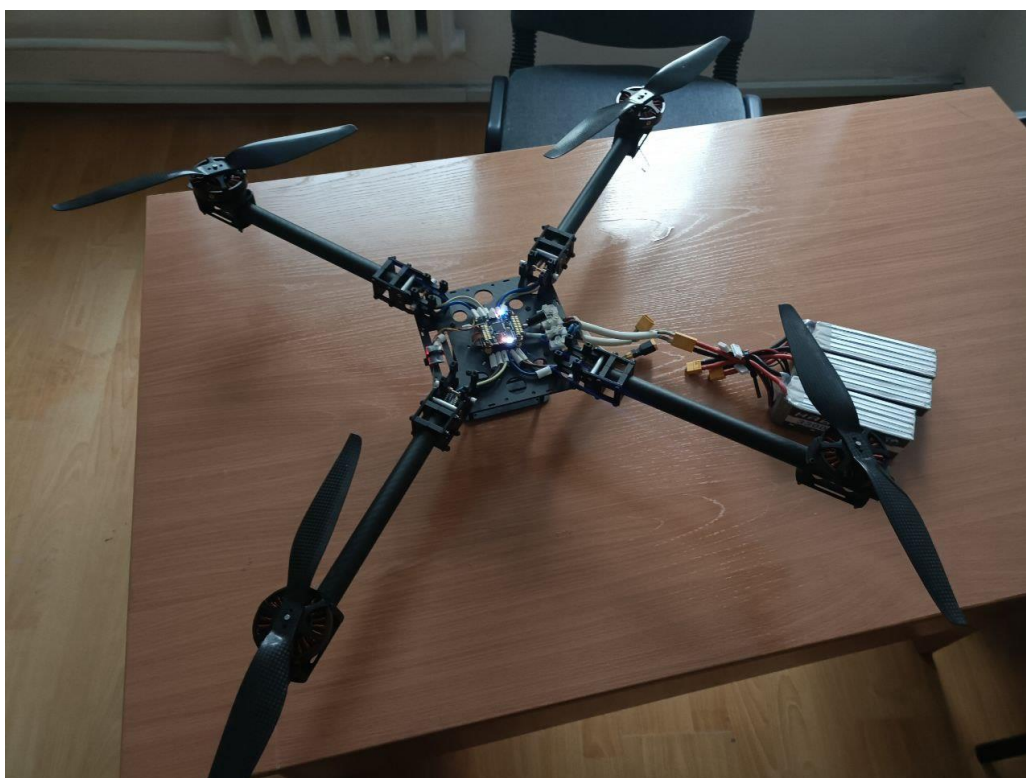
Рисунок 3.12 – Проверка БПЛА на тяговооруженность и длительный режим работы
